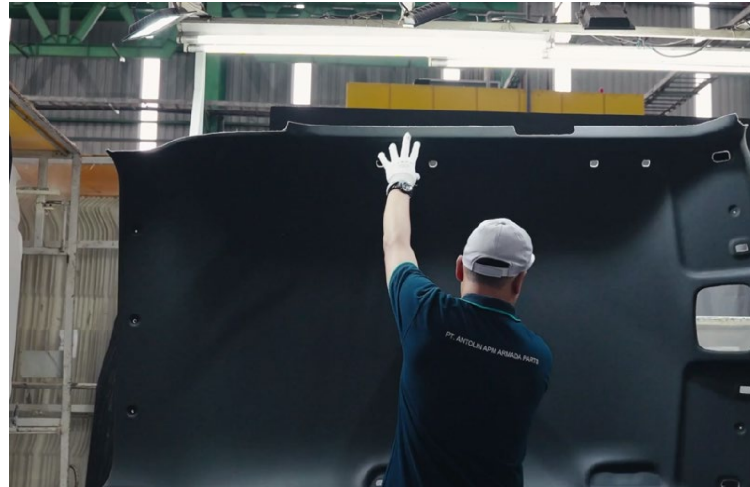
Sustrato de techo en la planta de Antolin en Indonesia.
